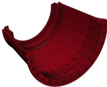
модель корпуса опоры авиадвигателя Матрица 2.5 млн строк, 184 млн. элементов
