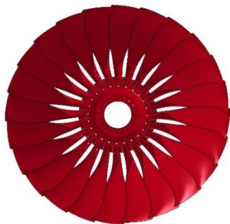
модель лопатки авиационного двигателя Матрица 2.5 млн строк, 174 млн. элементов
