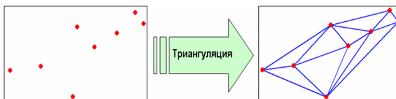
Рис. 2. Триангуляция Делоне, используемая при построении трехмерных выпуклых оболочек множества точек
