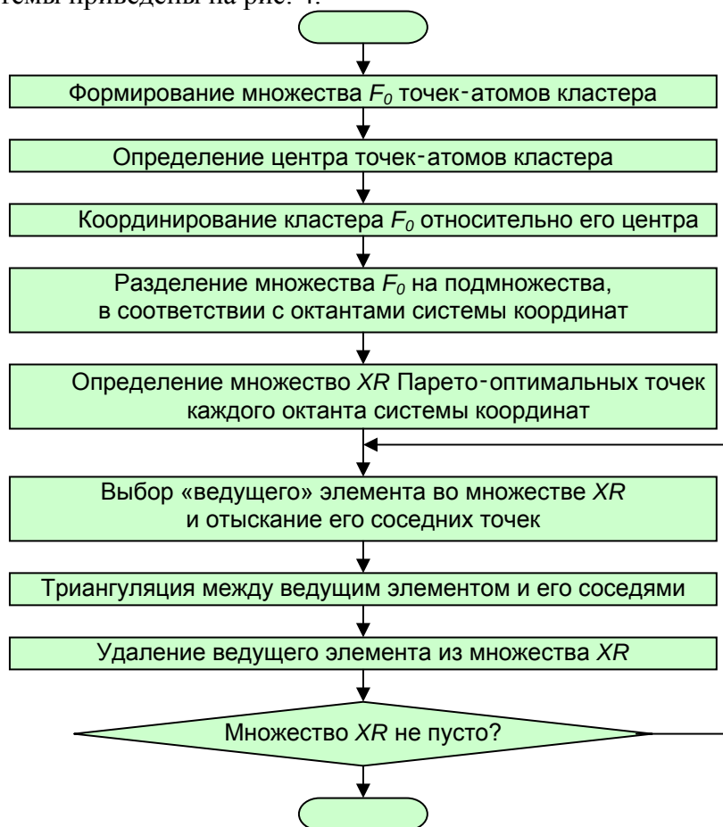
Рис. 3. Алгоритм построения трехмерной оболочки кластера
