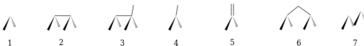
Рис. 1. Основные поверхностные структуры, выделяемые на плоскости (100) кристалла алмаза: 1 – мост, 2 – димер, 3 – димер с метил-радикалом, 4 – мост с метил-радикалом, 5 – высокий мост, 6 – мост на следующем слое, 7 – два моста
