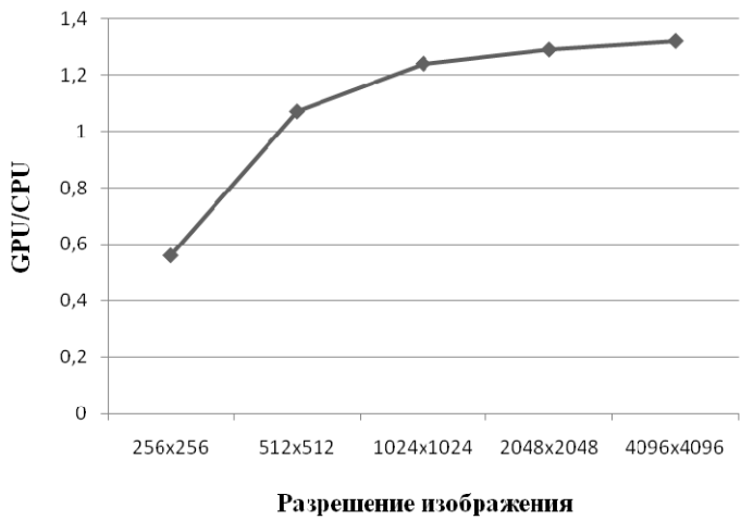
Рис. 2. Зависимость отношения ускорений GPU/CPU от разрешения изображения (алгоритм Харриса)
