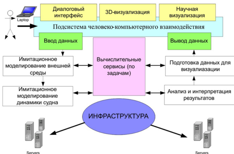
Рис. Концептуальная схема высокопроизводительного программного комплекса моделирования динамики морских плавучих объектов в экстремальных условиях эксплуатации
