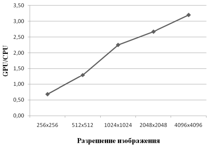
Рис. 1. Зависимость отношения ускорений GPU/CPU от разрешения изображения (функция conv2 )
