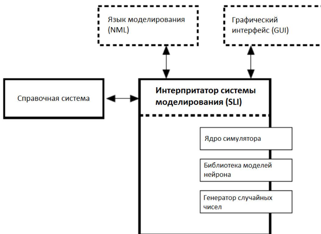
Рисунок 1. Архитектура нейросимулятора NEST.
