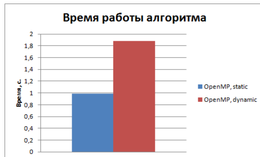
Рис 11. График сравнения времени выполнения параллельных алгоритмов со статическим и динамическим планированием.
