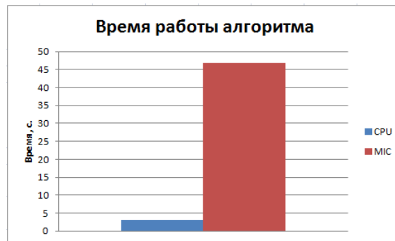
Рис 5. Сравнение времени вычислений простых чисел на CPU и MIC
