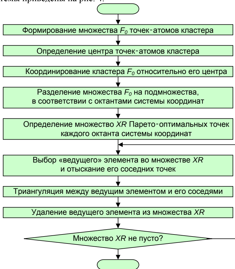
Рис. 3. Алгоритм построения трехмерной оболочки кластера
