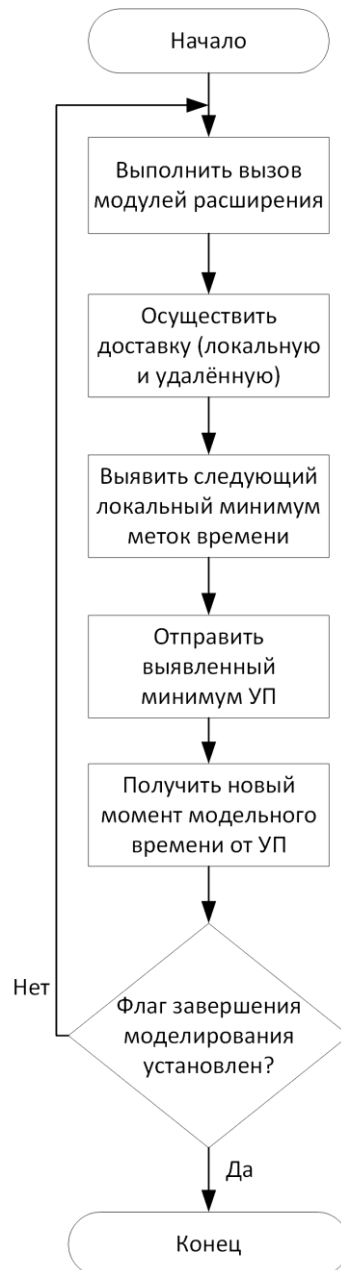
Рис. 3. Основной цикл работы МП ПСС после модернизации
