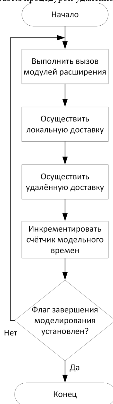
Рис. 1. Основной цикл работы МП ПСС
