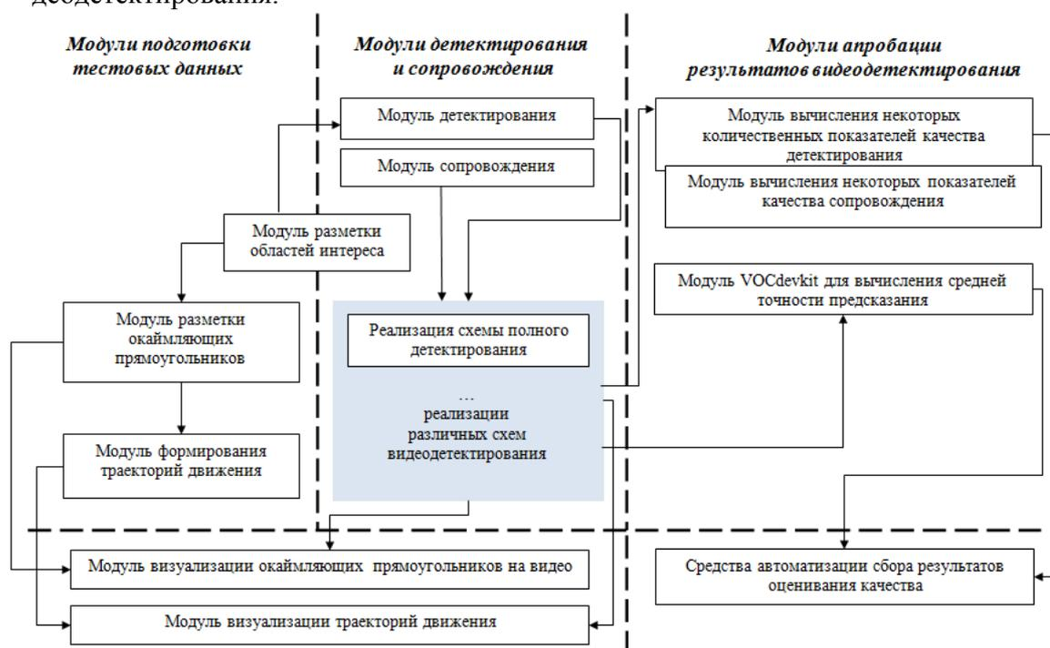
Рис. 1. Архитектура системы видеодетектирования транспортных средств
