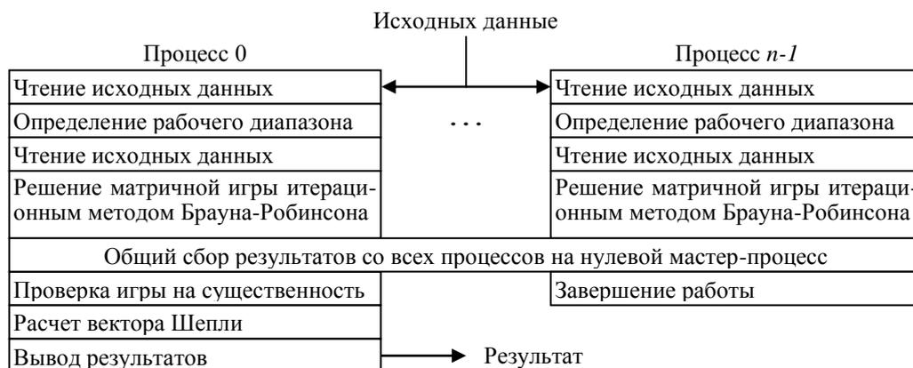
Рис. 1. Схема работы параллельного алгоритма решения кооперативной игры с использованием итерационного метода Брауна-Робинсона
