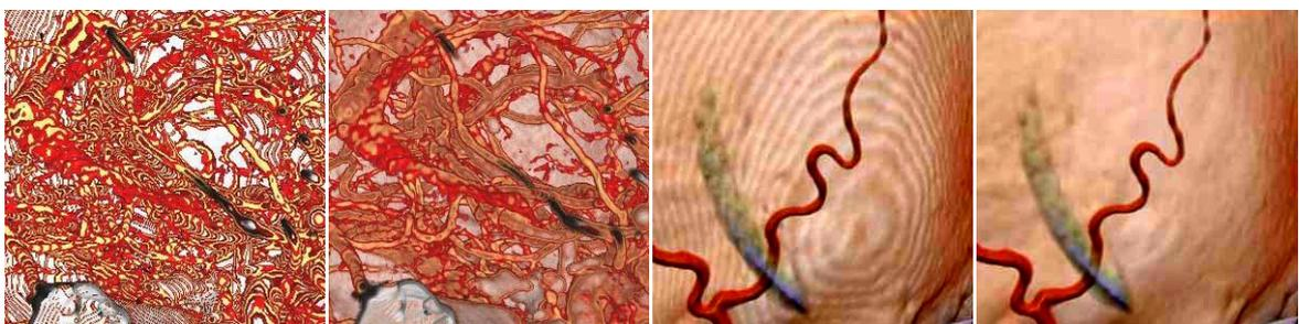
Рис 5. Слева направо: артефакты из-за пропуска лучом особенностей в данных; результат накопления изображений; артефакты при три-линейной фильтрации; использование три-кубической фильтрации
