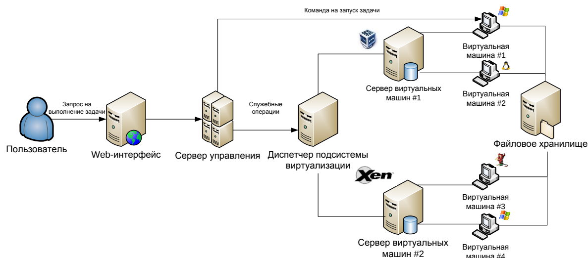
Рис. 2. Концептуальная схема работы подсистемы виртуализации
