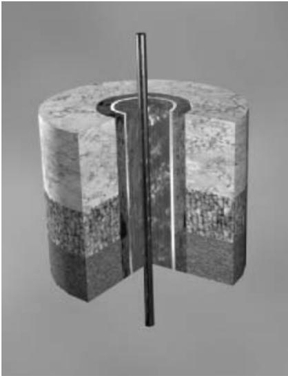
Рис. 2. Типичное скоростное строение среды при акустическом каротаже
