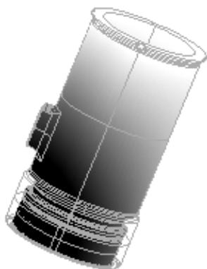
Рис. 4. Распределение температур в амортизаторе
