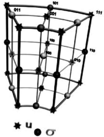
Рис. 1. Элементарная ячейка схемы Лебедева в цилиндрической системе координат. Компоненты тензора напряжений определены в узлах, отмеченных сферами, а компоненты скоростей смещений в узлах, помеченных звёздочками
