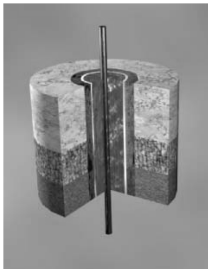
Рис. 2. Типичное скоростное строение среды при акустическом каротаже
