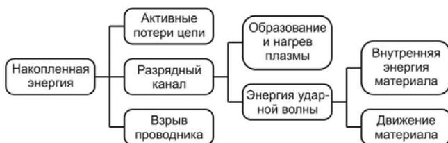
Рис. 1. Схема распределения энергии генератора
