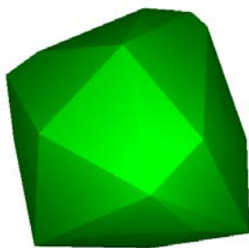
Рис. 2. Выпуклая оболочка и триангуляция для точек, равномерно распределенных в кубе
