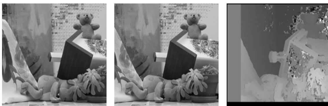
Рисунок 3. Тестовая стереопара и карта диспаратности.
