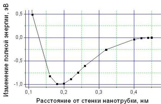
Рисунок 3 Изменение полной энергии как функция расстояния атома лития до центра шестиугольника на стенке нанотрубки.
