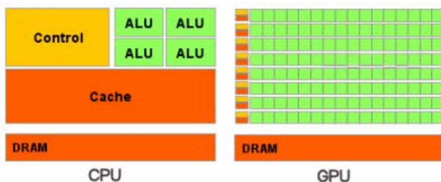
Рисунок 1. Архитектуры CPU - слева и GPU – справа.
