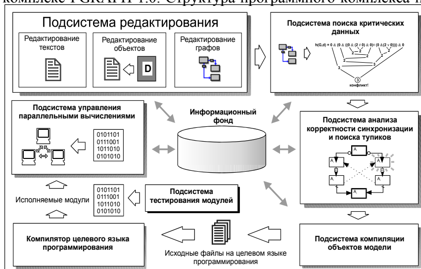
Рисунок 3. Структура программного комплекса PGRAPH 1.0.
