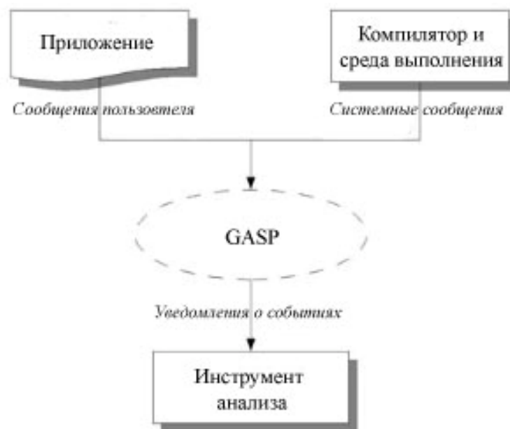
Рисунок 1. Высокоуровневая организация GAS приложения, выполняющегося в GASP реализации.
